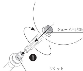
**!** ガラス製品の為、必要以上に締め付けると破損の恐れがあります。
