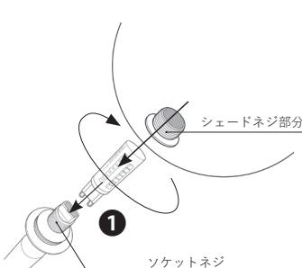
**!** ネジのかみ合わせに余裕がある設計のため、回転軸がずれないよう垂直に差し込み、スムーズに回転する位置でネジを締めでください。ネジのかみ合わせが斜めになると破損の原因となります。
