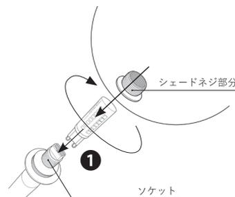
**!** ガラス製品の為、必要以上に締め付けると破損の恐れがあります。軽く固定が確認できた状態で回転(締め付け)を止めて下さい。
